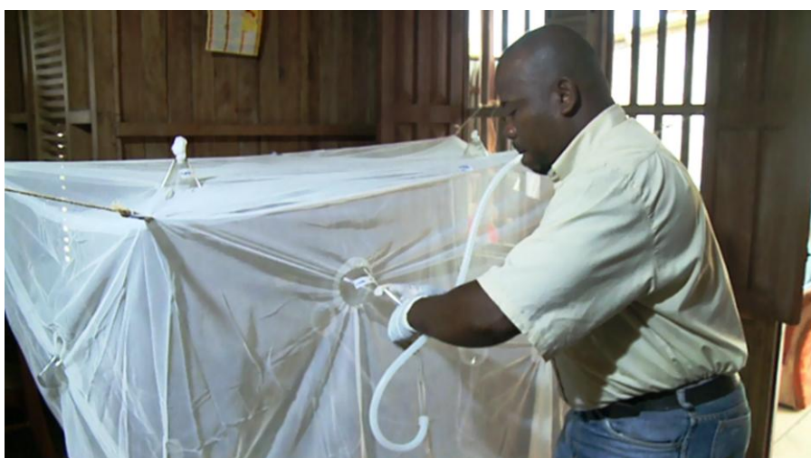
Figura 28. Bioensayo de conos de la OMS en un mosquitero tratado con insecticida
